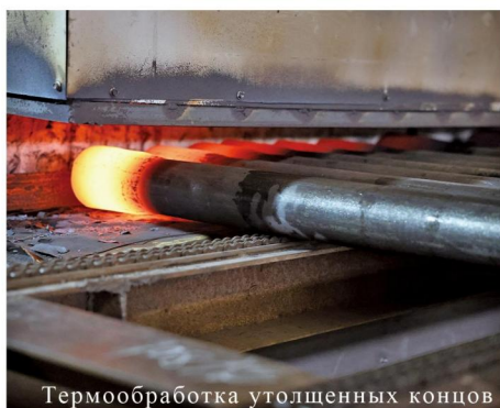
Термообработка утолщенных концов
