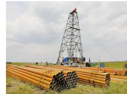
Бурильная труба с канатным керном в Анголе 1500 метров
